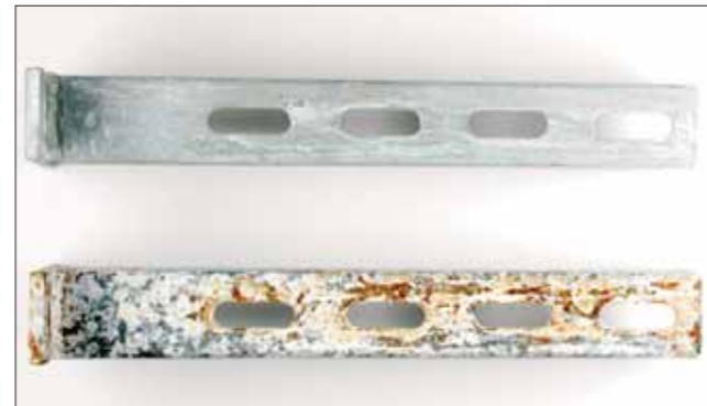
Auslegerkonsole 41/41 nach 1.440 h Salzsprühnebeltest; oben: zinklamellenbeschichtet unten: stückverzinkt
